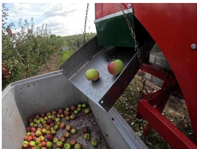
Рисунок 26 - Спосіб вивантаження плодів – контейнер
