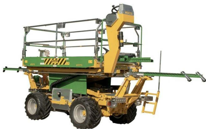
Рисунок 17 - Самохідні платформи для збору
