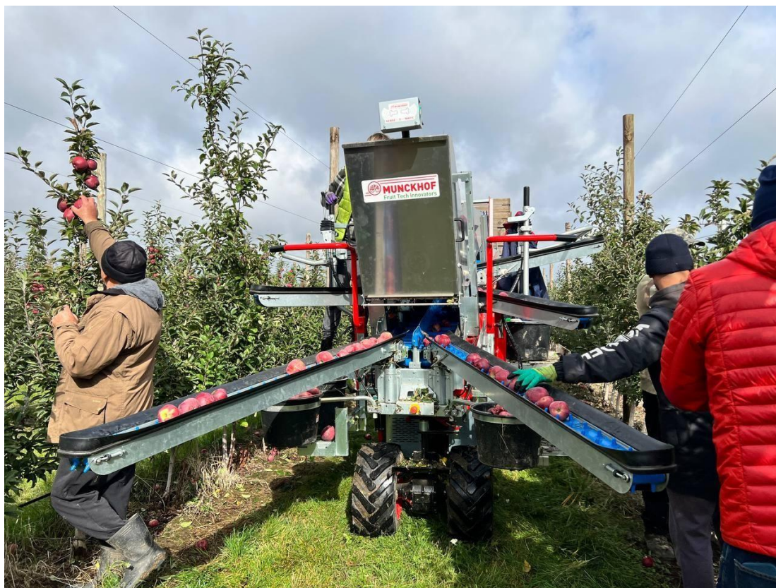
Рисунок 22 - Самохідна платформа в дії
