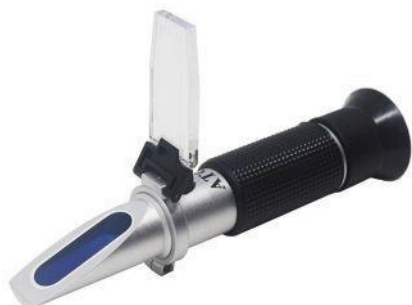
Рисунок 3 - Рефрактометр для визначення вмісту розчинних сухих речовин
