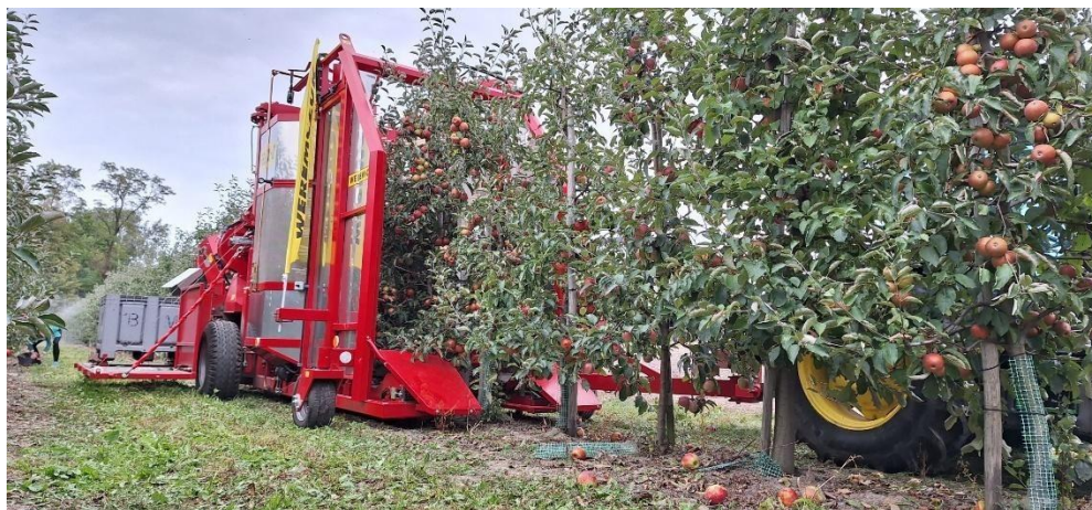
Рисунок 25 - Комбайн для збору промислового яблука Felix-Z
