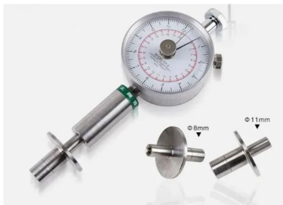
Рисунок 1 - Прилад для визначення твердості м'якуша
