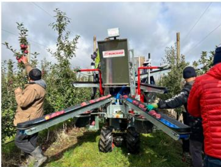
Подача плодів одразу на транспортер → менше пересипання і механічних пошкоджень
