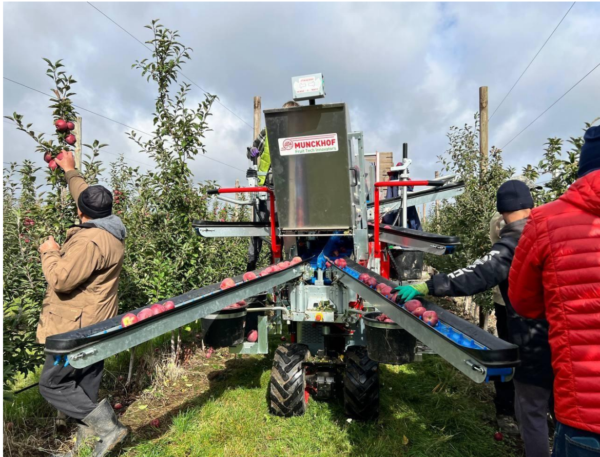
Abbildung22 – Selbstfahrende Plattform im Einsatz
