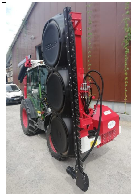
Це машина від Frutec , яка поєднує механічну літню обрізку з механічною дефоліацією
