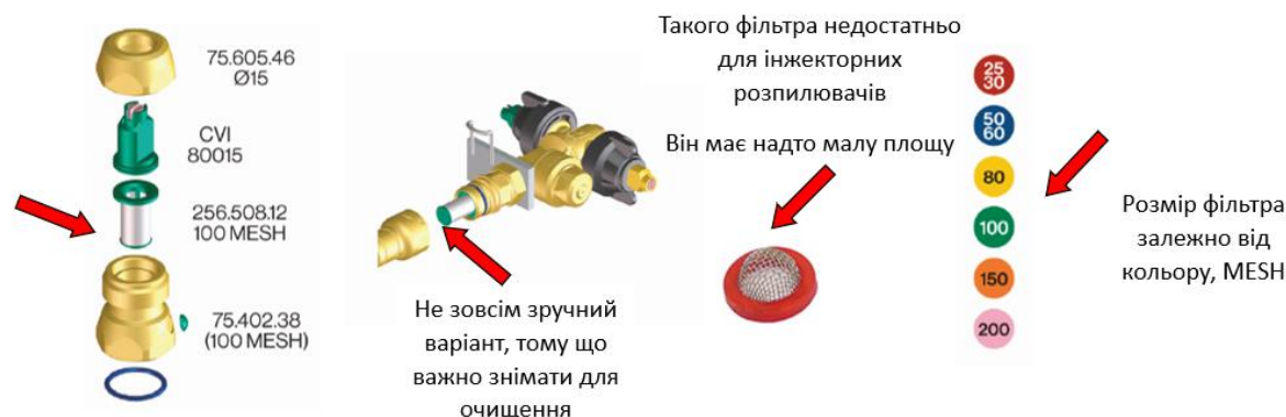
Рисунок 14 - Варіанти установки фільтра форсунки
