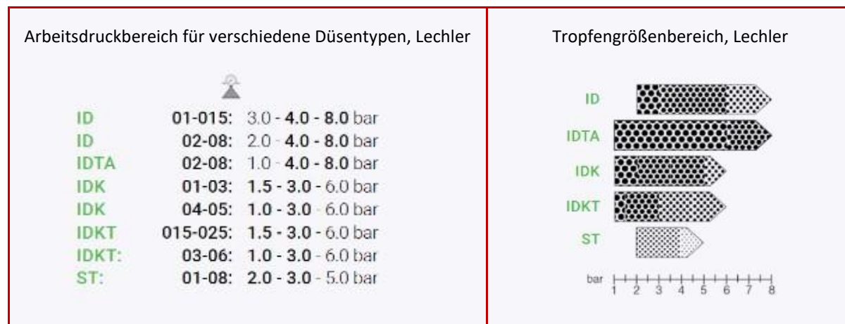
Abbildung 23 - Empfohlener Druck und Tropfengröße für verschiedene Sprühdüsen von Lechler.
