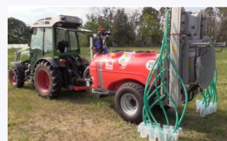
Ausliterung von Sprühgeräten
